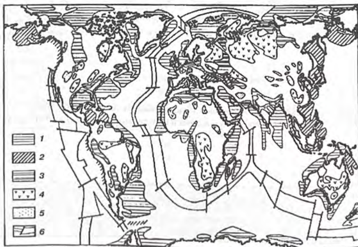
Рис. 1. Схема распространения глобальных поясов нефтегазоносности в современной структуре Земли (по В.Е. Хаину, Л.Э. Левину, 2001): глобальные пояса: 1 - современных пассивных окраин; 2 - активных; 3 - древних пассивных; 4 - внутриплатформенные синеклизы; 5 - межгорных впадин орогенов; 6 - срединно-океанические хребты
